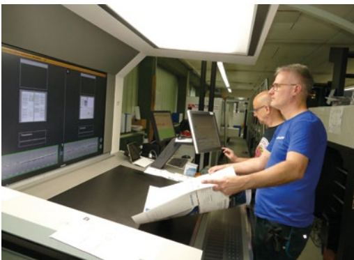
Schnell zum neuen Job: Die neue Komori GL-837P LED besticht unter anderem durch A-APC + Parallel Makeready: Druckplattenwechsel, Gummituchreinigung, Farbprofilaufbau sowie die Voreinstellungen für Luft und Register laufen mithilfe von Parallel Makeready simultan in gerade einmal zwei Minuten.
